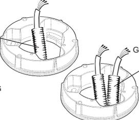
IT N.B.: Per il collegamento elettrico alla rete, servirsi dell'art. X188 - X189 - X562 - X478 - BZN7 - PA03 o di altri dispositivi di connessione in classe II che garantiscano il grado di protezione IP66.
