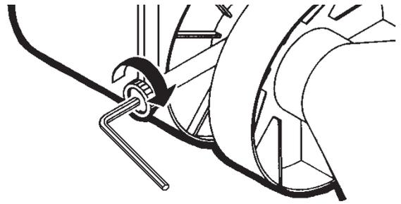
IT Nella necessità di bloccare completamente l'orientamento verticale, serrare con un utensile come indicato in figura.
