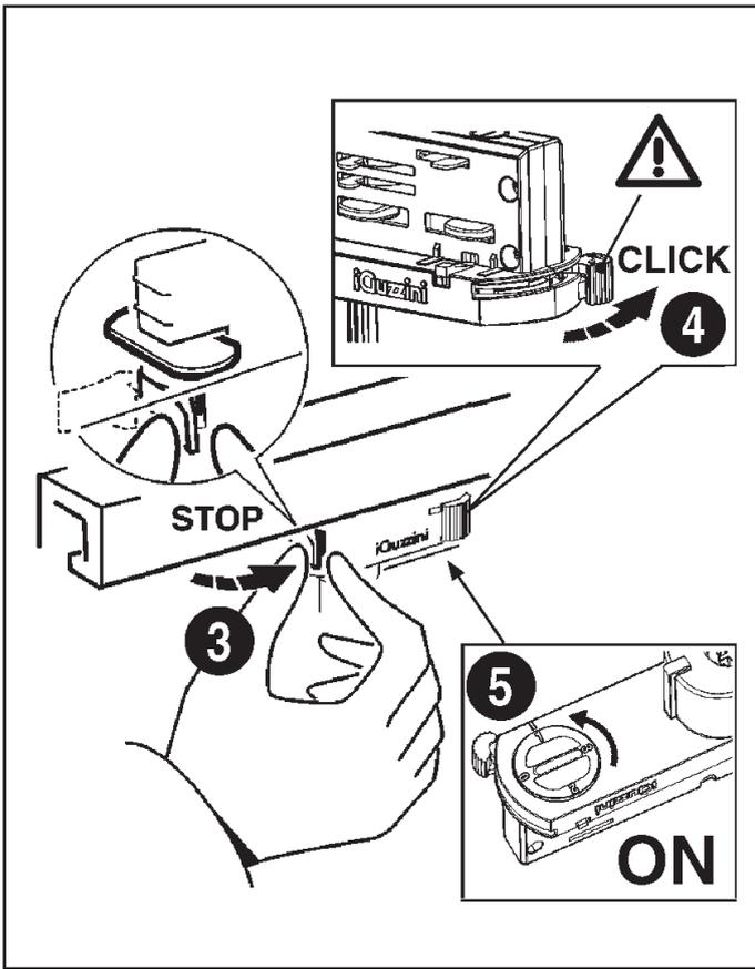
INSTALLAZIONE DELLO SPOT CON BASETTA
