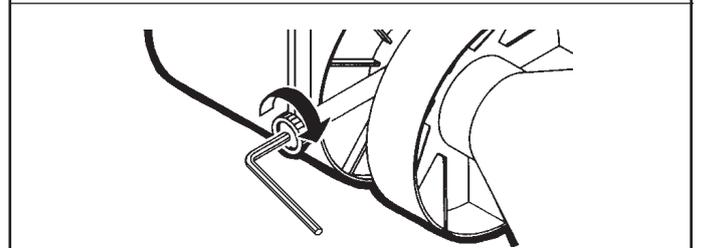
I Nella necessità di bloccare completamente l'orientamento verticale, serrare con un utensile come indicato in figura.
