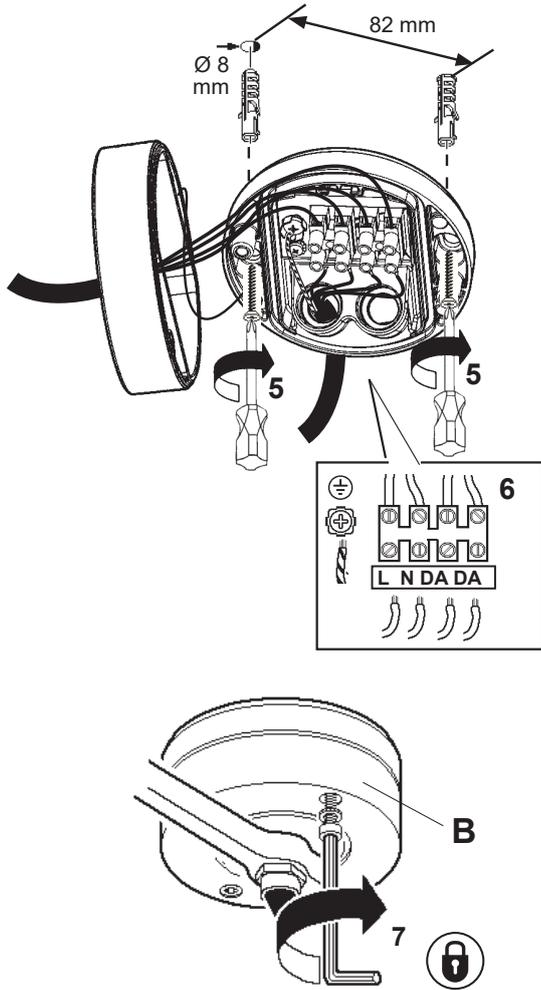
IT Per la corretta chiusura della basetta "B", posizionare il particolare come indicato in figura, evitando la schiacciatura dei cavi elettrici.
