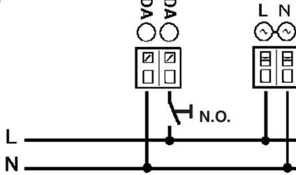
AR يمكن أن يتم تخفيض إضاءة الأجهزة ذات الكابلات الرقمية؛ وذلك عن طريق استخدام أجهزة الإمداد بالطاقة الكهربائية "دالي" (DALI)، أو عن طريق استخدام زر يكون مفتوحًا في وضعه الطبيعي (N.O.)؛ حيث يتم التوصيل كما هو مبين في المخطط.
