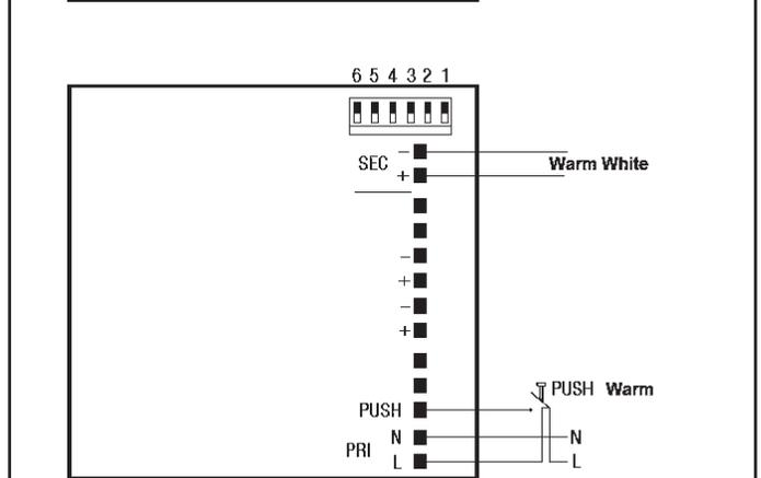
**DE** Die Geräte mit digitaler Verkabelung können mit Hilfe von DALI-Vorrichtungen oder mit Hilfe eines gemäß Schaltplan anzuschließenden Schließers (N.O.) gedimmt werden.
