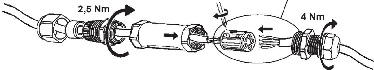
**IT** N.B.: Per il collegamento elettrico alla rete, servirsi degli art. BZS6 o di altri dispositivi di connessione che garantiscano il grado di protezione IP67.
