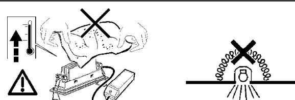
IT N.B.: Apparechi non idonei ad essere coperti di materiale termicamente isolante
