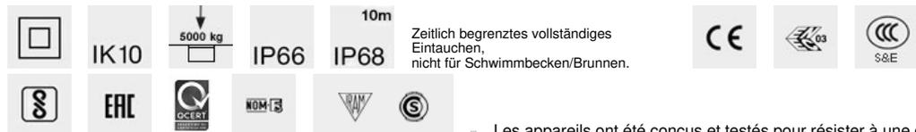
□ Les appareils ont été conçus et testés pour résister à une charge statique maximale de 50000 N et résistent au passage de véhicules équipés de pneus. Les appareils ne peuvent pas être installés dans les voies où ils sont soumis à des contraintes horizontales dues à l'accélération, au freinage et / ou aux changements de direction.
