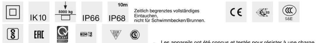
Les appareils ont été conçus et testés pour résister à une charge statique maximale de 50000 N et résistent au passage de véhicules équipés de pneus. Les appareils ne peuvent pas être installés dans les voies où ils sont soumis à des contraintes horizontales dues à l'accélération, au freinage et / ou aux changements de direction.
