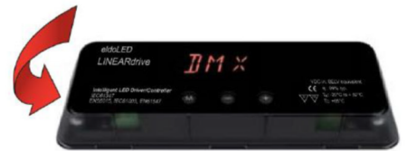
G Riposizionare la copertura
