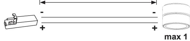
**IT** La iGuzzini testa e garantisce la funzionalità del sistema alimentatore/prodotti fino a una distanza massima di 50mt. Per lunghezze superiori è responsabilità del cliente verificare le condizioni di sicurezza e di funzionamento.
