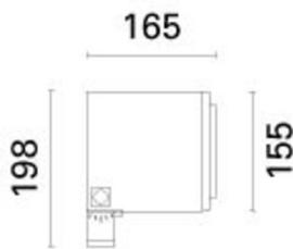
**Référence produit**BX12: Projecteur sur étrier - LED COB Neutral White - alimentation électronique gradable 1-10 Volts (220 ±240Vac 50/60Hz) - optique wide flood **Attention ! Code abandonné****Description technique**
