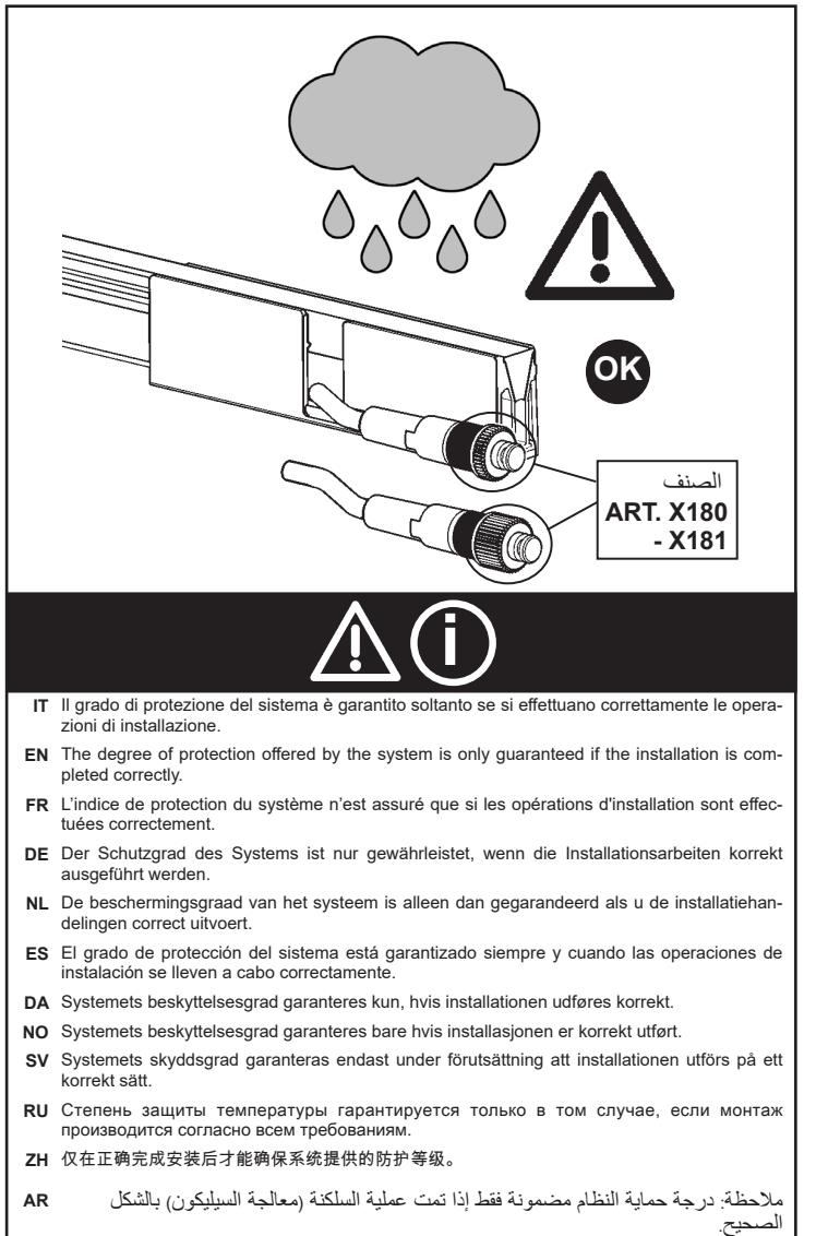
**IT** Il grado di protezione del sistema è garantito soltanto se si effettuano correttamente le operazioni di installazione.
